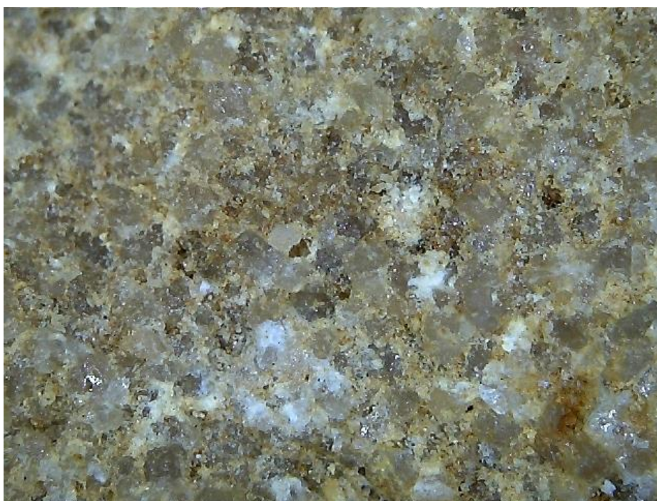
Fot. 2. Widok powierzchni naturalnego przełamania piaskowca (próbka nr 1). Mikroskop stereoskopowy. Powiększenie 30X. Ziarna szkieletu połączone spoiwem krzemionkowo-żelazisto-ilastym.
