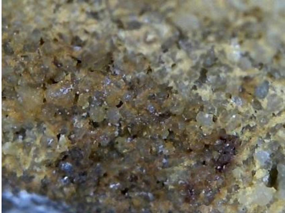
Fot. 17. Widok powierzchni naturalnego przełamu piaskowca (próbka nr 2). Mikroskop stereoskopowy. Powiększenie 30X. Rdzawe zabarwienie powierzchni piaskowca wywołane rozkładem hematytu.
