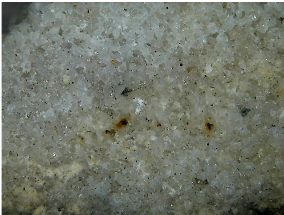
Fot. 16. Widok powierzchni naturalnego przełamania piaskowca (próbka nr 2). Mikroskop stereoskopowy. Powiększenie 30X. Na powierzchni piaskowca widoczne są rdzawe skupienia hematytu.
