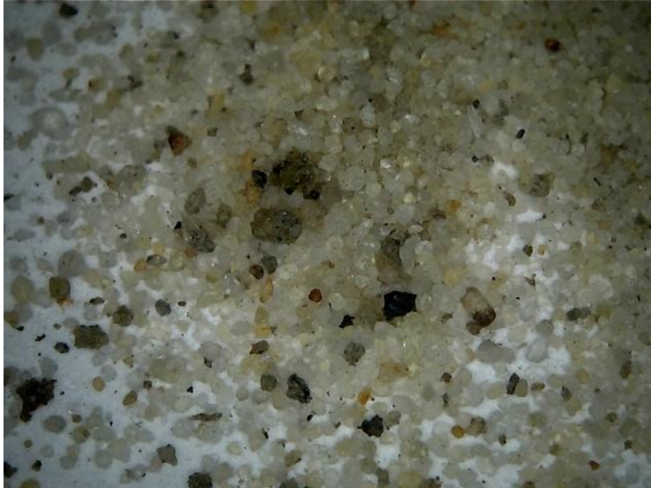
Fot. 23. Ziarna rozkruszonego piaskowca (próbka nr 3). Mikroskop stereoskopowy. Powiększenie 30X. Ziarna magnetytu (czarne) i hematytu (rdzawe).
