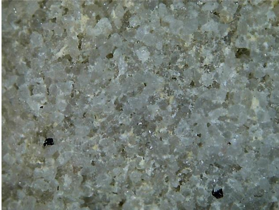
Fot. 15. Widok powierzchni naturalnego przełamania piaskowca (próbka nr 2). Mikroskop stereoskopowy. Powiększenie 30X. Ziarna kwarcu połączone spoiwem. Widoczne są pojedyncze ziarna magnetytu (czarne).
